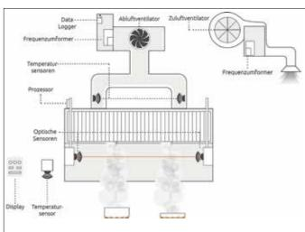
Das Cheetah-Funktionsprinzip: Mit optischen und thermischen Sensoren sorgt die Steuerung bei Hochbetrieb für maximale Ventilation. Bei wenig Kochaktivität wird die Abluft automatisch gedrosselt.
